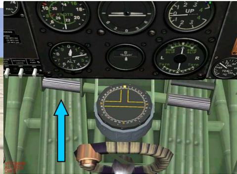
La plupart des avions à train classique ont une roulette de queue « folle ». C'est le flux d'air sur la dérive qui fait tourner à droite ou gauche l'avion suivant l'appui sur le palonnier - et non la roulette elle-même.
