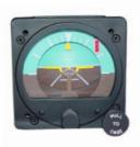
L'horizon artificiel est un instrument important car il permet simultanément de maintenir une assiette et de mesurer une inclinaison. Attention, cet instrument n'indique pas le taux de virage.
