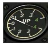
Ce Variomètre indique une montée stabilisée d'environ 800 ft/mn
