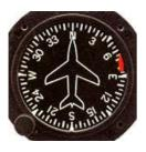
Le conservateur de cap présente l'avantage de conserver une référence de cap choisie par le pilote, quelle que soit la phase de vol de l'avion (montée, descente, variation de vitesse, virage, ...).
